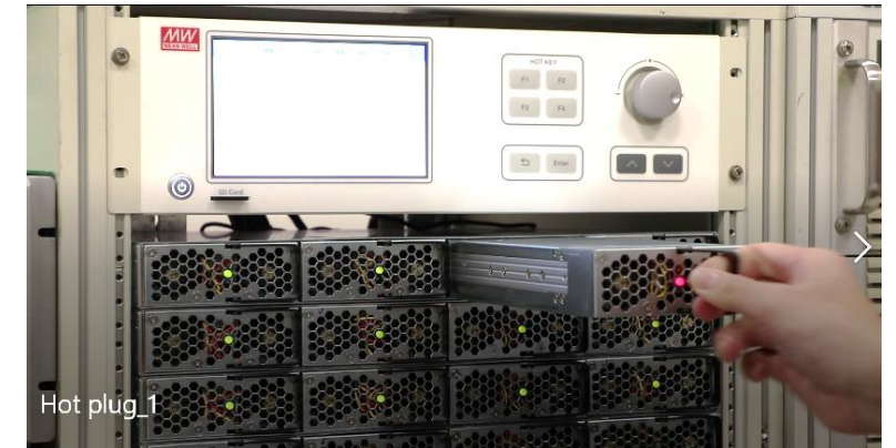
Управляемая система питания в Rack-стойке
